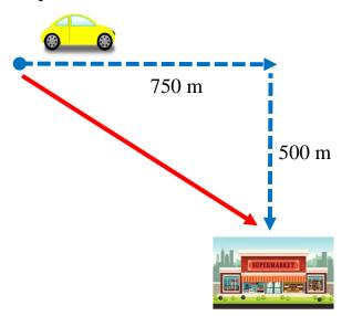
Distance (d) = 750 m + 500 m = 1250 mDisplacement  $\Delta x = 901 \text{ m}$  SE
